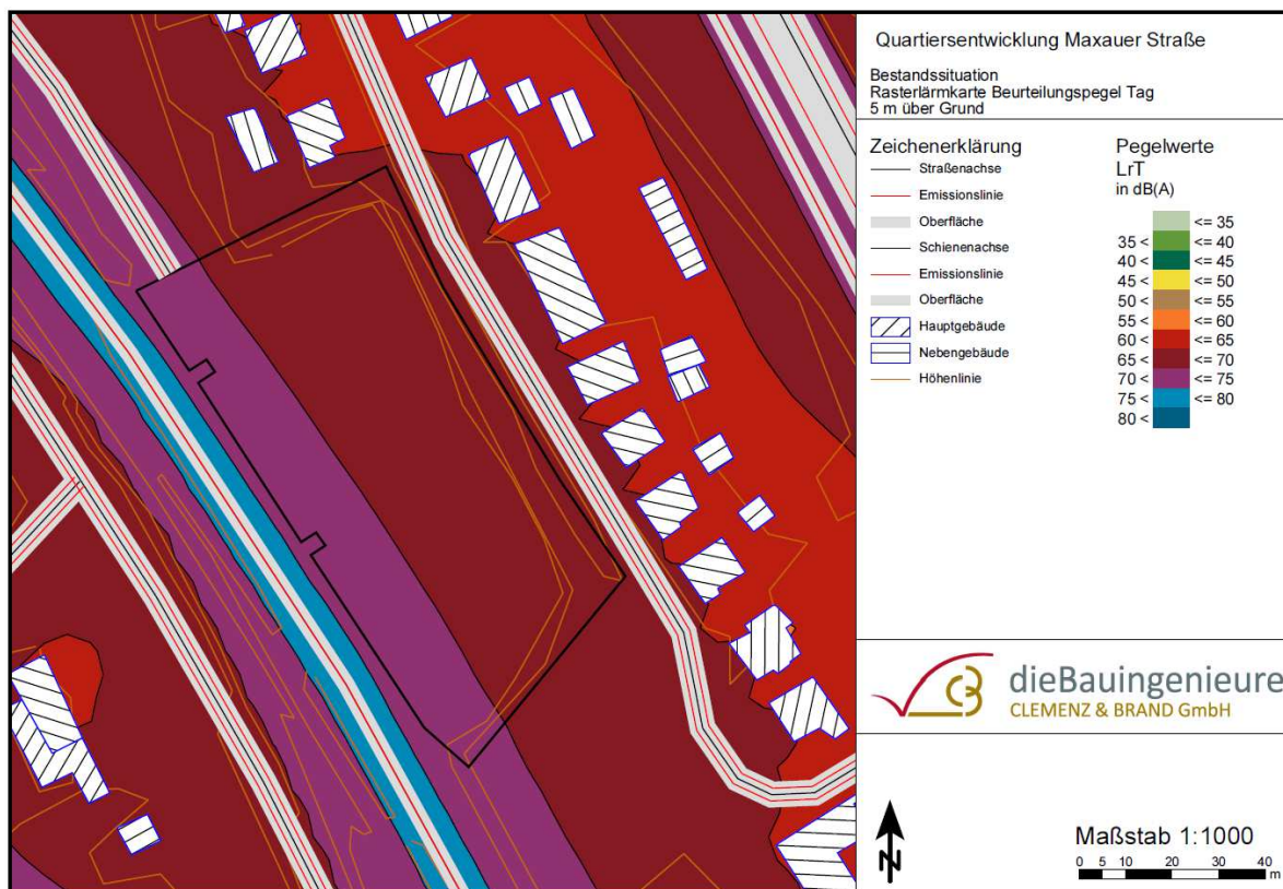
Abb. 3-4: Ermittelte Bestandsituation Rasterlärmkarte 5 m über Grund, tagsüber - Maxauer Straße, DIEBAUINGENIEURE (2017) (nicht maßstabgetreu)
