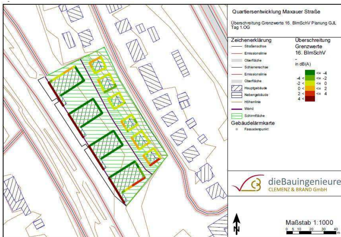
Abb. 4-5: Überschreitung Grenzwerte 16. BImSchV an der Bebauung (nachts Erdgeschoss)
