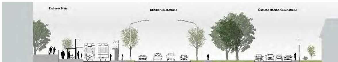
Abbildung 32: Straßenquerschnitt der Rheinbrückenstraße mit Elsässer Platz und Östlicher Rheinbrückenstraße (Bestand), eigene Darstellung
