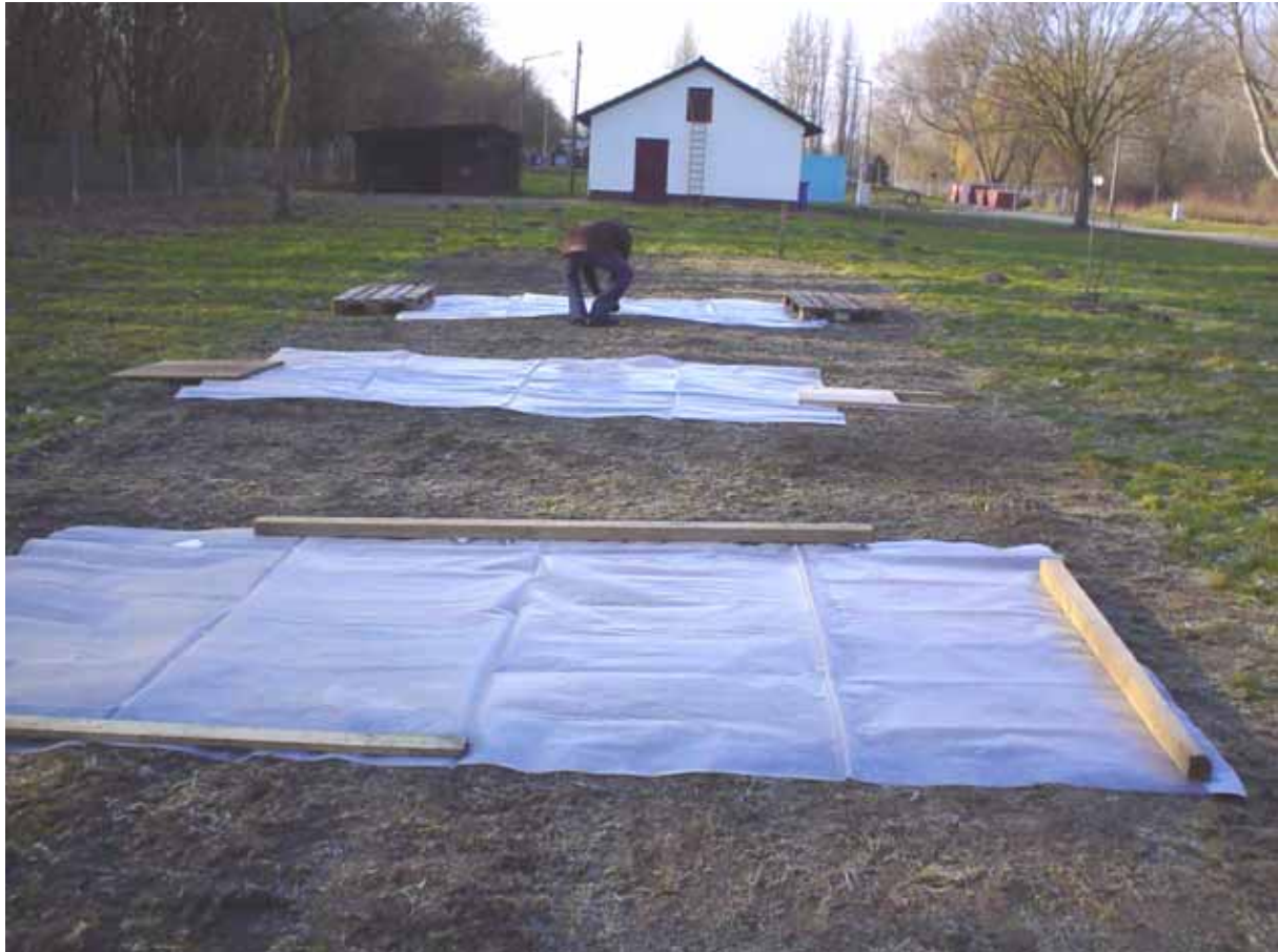
Bild 2: Probenahmeplatten auf einer Wiese im Klärwerk Karlsruhe
