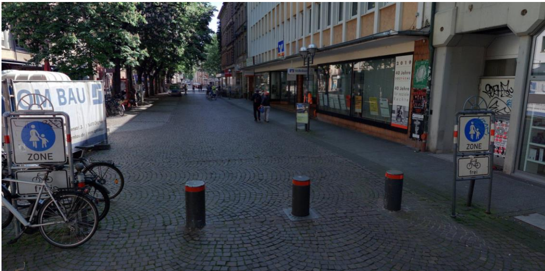
Abbildung 1 Halbautomatisches, hydraulikgestütztes System am Werderplatz
