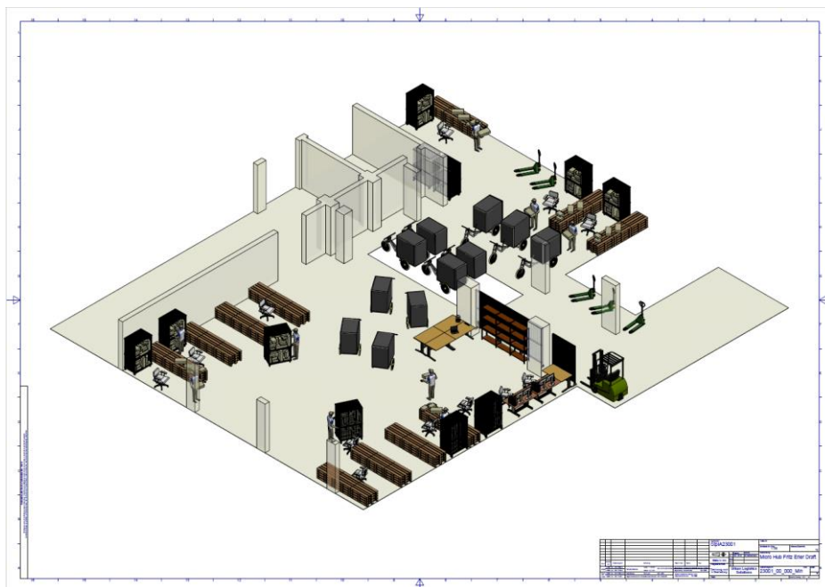
Abbildung 2: Vorgeschlagene Flächenaufteilung des Micro-Hubs für einen KEP-Dienst mit 11 Lastenrädern 2
