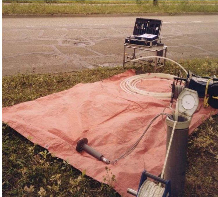
Abbildung 84: Grundwasserstandsmessungen und Beprobung einer Grundwassermessstelle. Foto: Eurofins Umwelt West GmbH.
