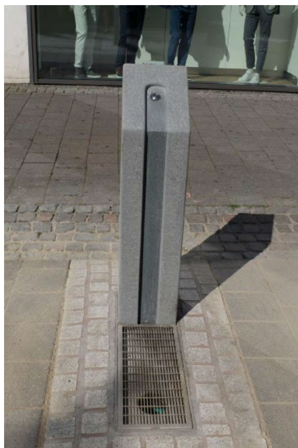
Abbildung 54: Trinkbrunnenmodell für den diskontinuierlichen Betrieb, Material Granit, Kosten Brunnenkorpus 9.500 EUR, Foto: Kalkmann Brunnenkunst
