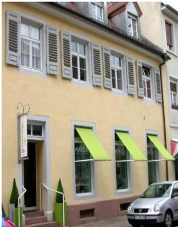
Unproportionale Konstruktionen und die Verwendung unangemessener Materialien können hingegen den gestalterischen Gesamteindruck einer Fassade zerstören. Insbesondere durch massive, über das ganze Gebäude hinweg gezogene und weit auskragende Vordächer kann der Blick auf die Obergeschosse versperrt und die Fassade der Obergeschosse optisch „abgeschnitten“ werden.
