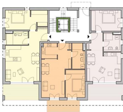
Haustyp 2 Dreispänner Grundriss Erdgeschoss
