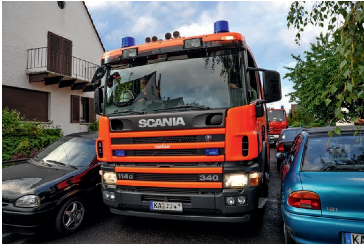
Probleme beim Unterschreiten der Mindestfahrbahnbreite von 3,10 m für Rettungsfahrzeuge und Müllabfuhr
