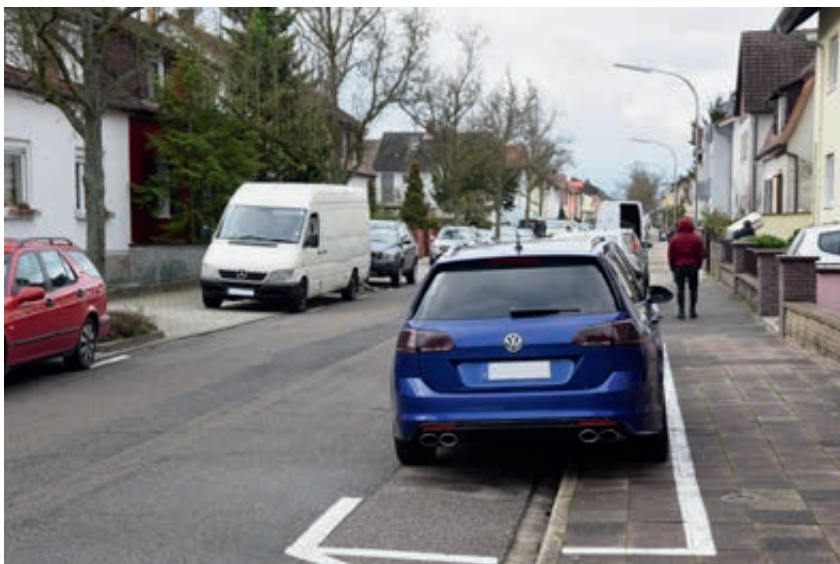
Legalisiertes Gehwegparken durch Markierung
