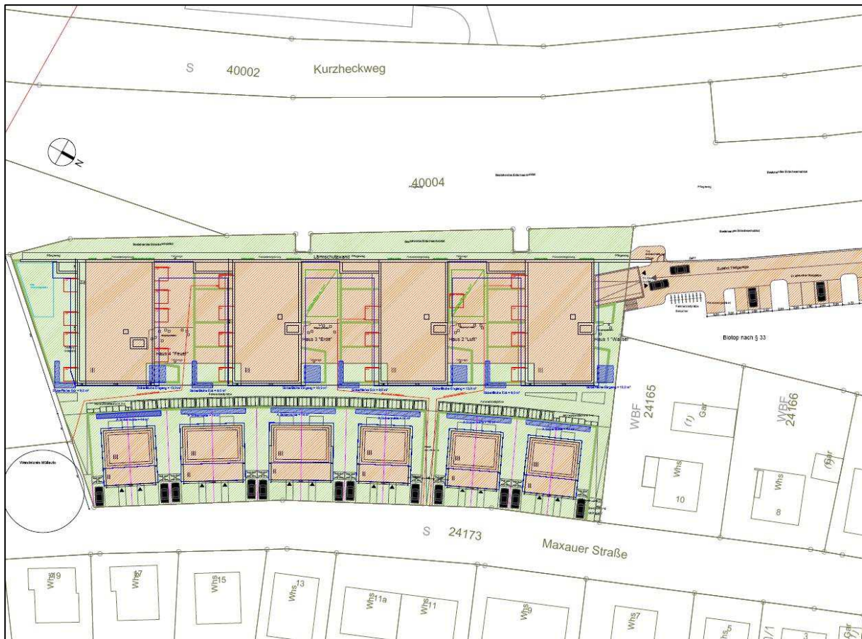
Abb. 4-1: Lageplan Aushubflächen und Auffüllung: ausschließlich Bodenabtrag (orange), Bodenabtrag mit anschließender Verfüllung (grün), Versickerungsanlagen gemäß Vorplanung (blau) – nicht aktuell, Änderungen vom 03.05.2017 noch nicht dargestellt (GHJ 2017a)
