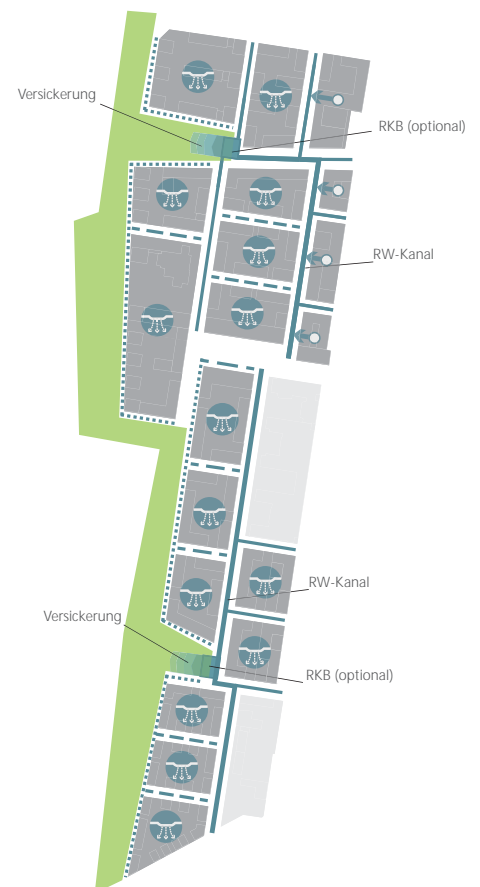
Regenwasserspeicherung, Ableitung und Versickerung
