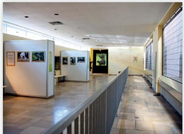
Ein Beispiel für die bauliche Überarbeitung im **Giraffenhaus** sind die Geländer, die an die derzeitigen Sicherheitsvorschriften angepasst werden müssen. Ebenfalls – wie beim Raubtierhaus – muss die Fernwärmeversorgung geändert werden. Die vorhandene Lüftungsanlage ohne Wärmerückgewinnung muss ausgetauscht werden. Aus tiergärtnerischer Sicht sind die Anforderungen an den Außen- und Innenbereich nach dem Säugetiergutachten von 2014 nicht erfüllt.
